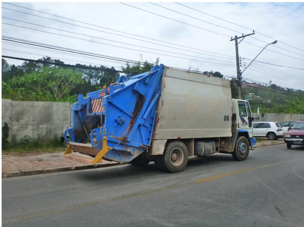
Figura 56. Um dos caminhões compactadores que realiza a coleta de resíduos sólidos em Campo Limpo Paulista, com sete toneladas de capacidade de carga
